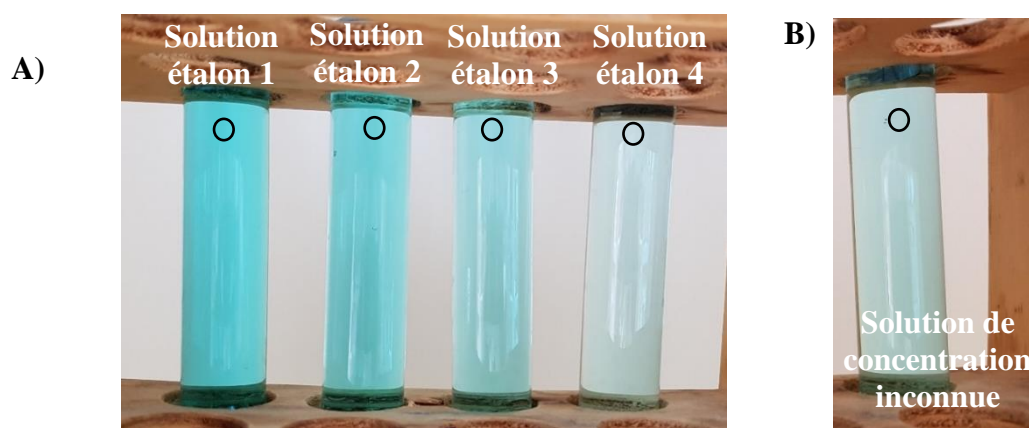
Figure 1. A) Photo des 4 éprouvettes remplies avec les solutions de calibration contenant différentes concentrations en \text{CuSO}_4 avec les zones de pixels analysées (cercles noirs) par l'application. B) Photo de la solution de concentration inconnue en \text{CuSO}_4 avec la zone de pixels analysée (cercle noir).
