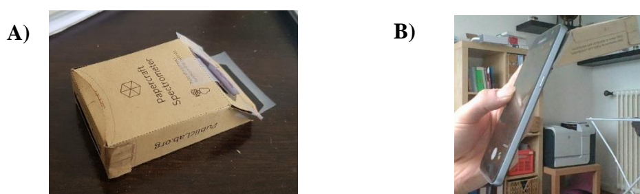
Figure 4 : A) Spectromètre DIY en papier-carton. B) Spectromètre fixé sur la caméra du smartphone.
